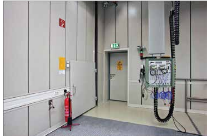
5 Пример реализованной акустической камеры IAC Acoustics с материалом PlanarCHOIC
