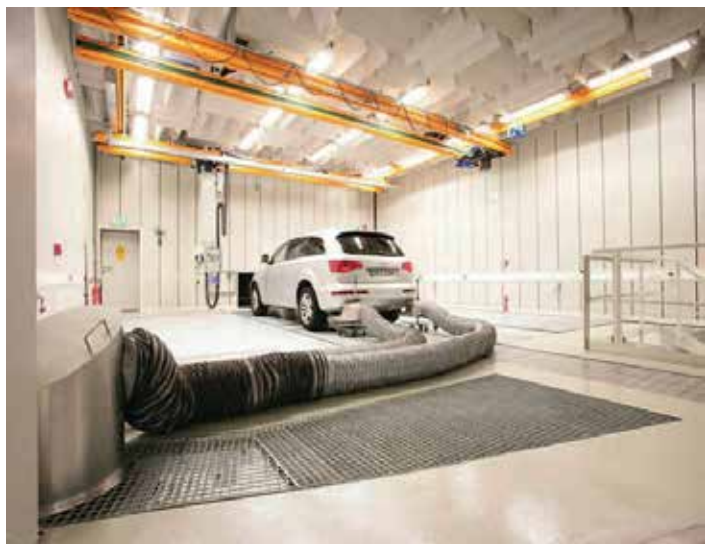
10 Полубезэховая камера с плоскими поглотителями на стенах и с клиньями на крыше для увеличения эффективности поглощения
