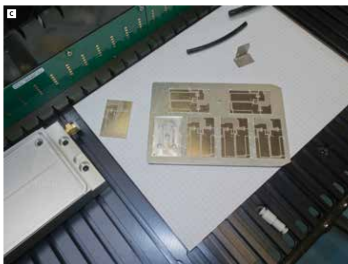
Вакуумный держатель с нагревателем A , B для монтажа на керамические платы C
