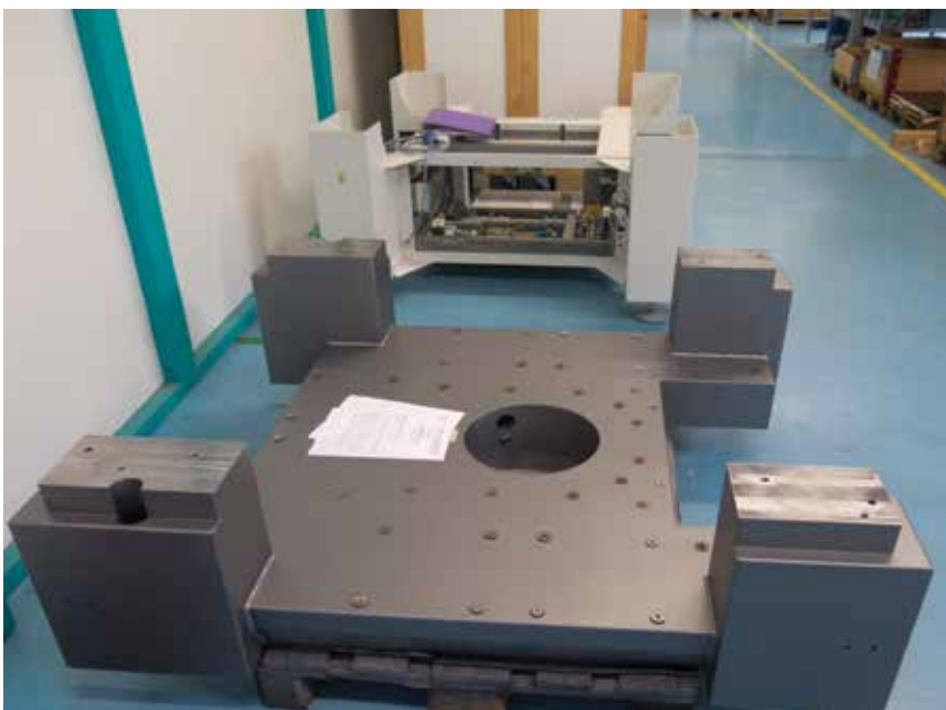
Станина с протоколом входного контроля, выполненного сторонней компанией
