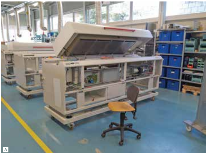
Линия сборки печей оплавления — конвейерных A и настольных B
