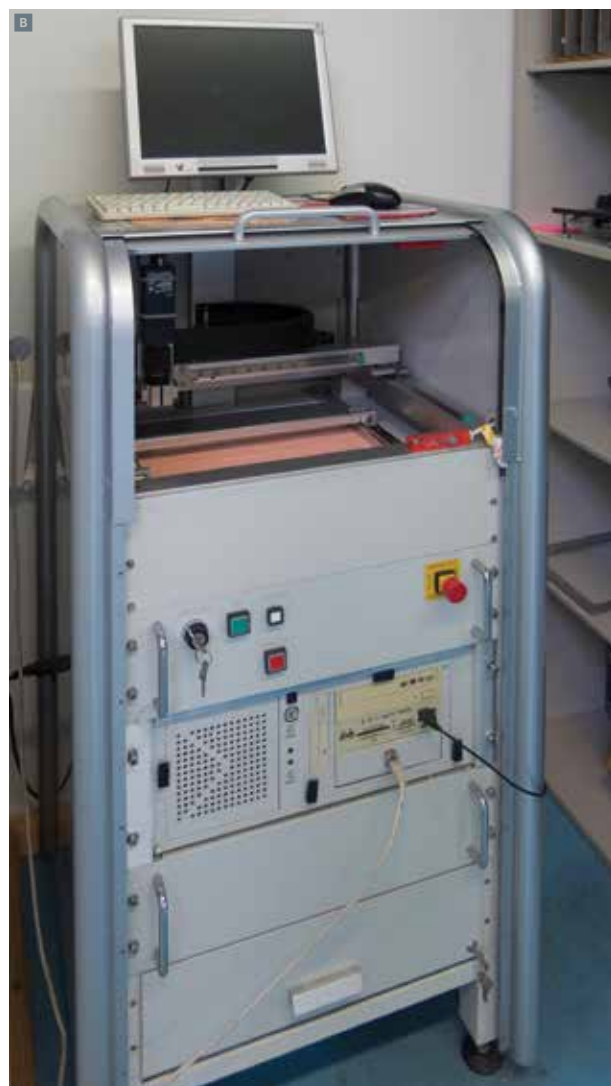
Контроль точности дозирования: материал наносится на стеклянную пластину A и в специальной установке B измеряется разброс от заданных точек C
