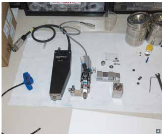
Сборка дозаторов A . Готовые дозаторы сначала тестируются на стенде B , затем — в составе установки Scorpion A
