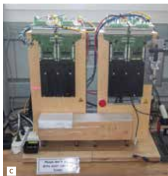
Участок сборки голов A . Собранные головы B перед тестированием на испытательном стенде C . Проверенные головы на стеллажах хранения D
