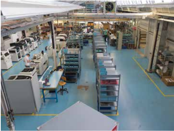
Один из цехов. Слева — зона подготовки б/у оборудования, по центру — участок изготовления и тестирования питателей
