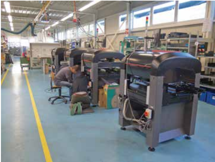
Линия сборки малых установочных автоматов Pantera
