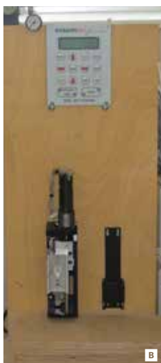
Сборка дозаторов A . Готовые дозаторы сначала тестируются на стенде B , затем — в составе установки Scorpion A
