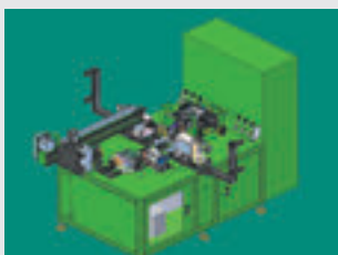
Машина TEAM для намотки и сварки якоря AWFM2000
