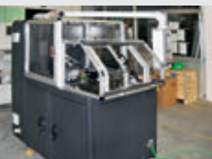
Машина TEAM для намотки и сварки якоря AWFM2000
