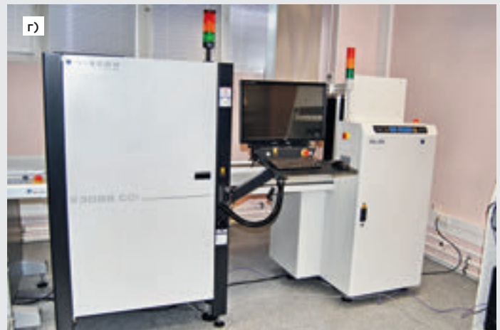
Линия нанесения влагозащитных покрытий: а – система струйной очистки Super Swash; б – система селективного нанесения ВЗП Nordson Asymtek SL-940 и установка ультрафиолетового отверждения Nordson Asymtek UV9. Справа – угловой конвейер к оптической инспекции; в – рабочая зона системы SL-940. Трубки красного цвета – линии подачи материала к аппликатору, которые надо перестыковывать при переходе с одного типа покрытий на другой; г – АОИ Viscom S3088 CCI
