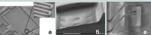
Рис. 6 Примеры обработки различных поверхностей топологии: а – травление большой поверхности подложки; б – травление полостей на нижней плоскости полости; в – травление полостей на боковых поверхностях топологии
