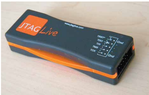
Рис. 1. Контроллер JTAG Live с одним TAP-портом и USB-интерфейсом
