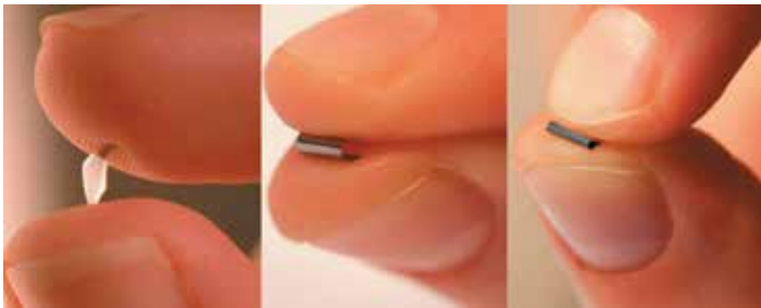
4 Гибкость утоненного кристалла. Толщина кристалла 18 мкм. Источник: IMS-chips
