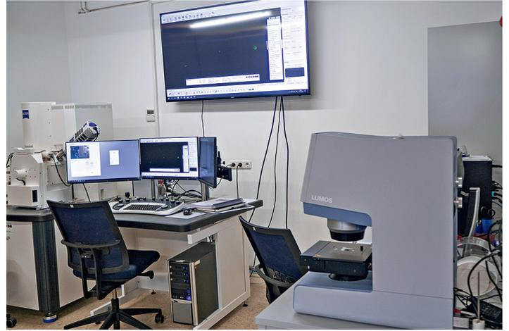
Сканирующий электронный микроскоп (слева) и ИК-Фурье-микроскоп (справа)
