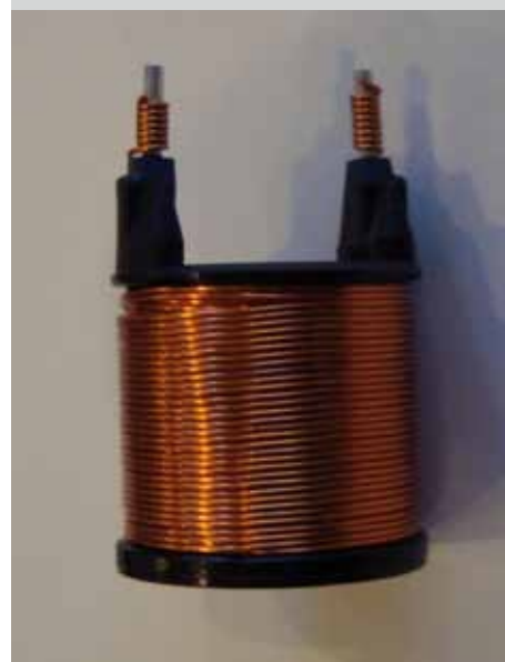
Рис. 1-2 Пример изделия проволочным выводом, фиксация провода методом намотки
