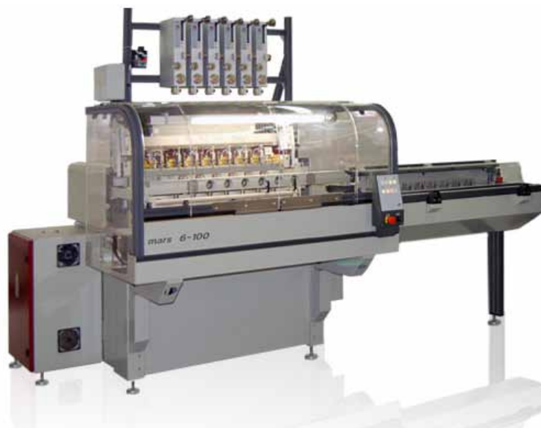
Рис. 3 Многошпиндельный намоточный станок серии MARS с возможностью интеграции в производственную линию
