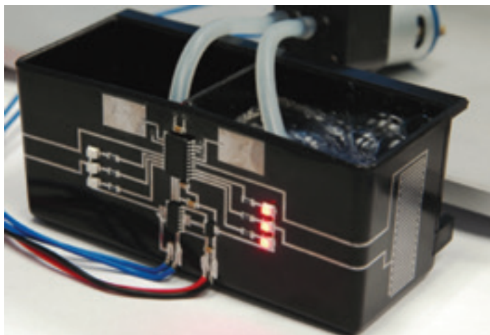
7 Прототип датчика уровня заполнения бака, выполненный с помощью технологии прямой печати
