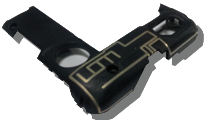
6 Антенна для мобильного телефона - массовый продукт, изготавливаемый с помощью AJ-45X
