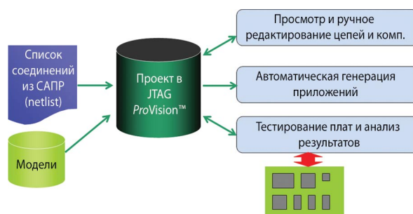
Рис. 1. Принцип работы профессиональных средств JTAG-тестирования на примере JTAG ProVision
