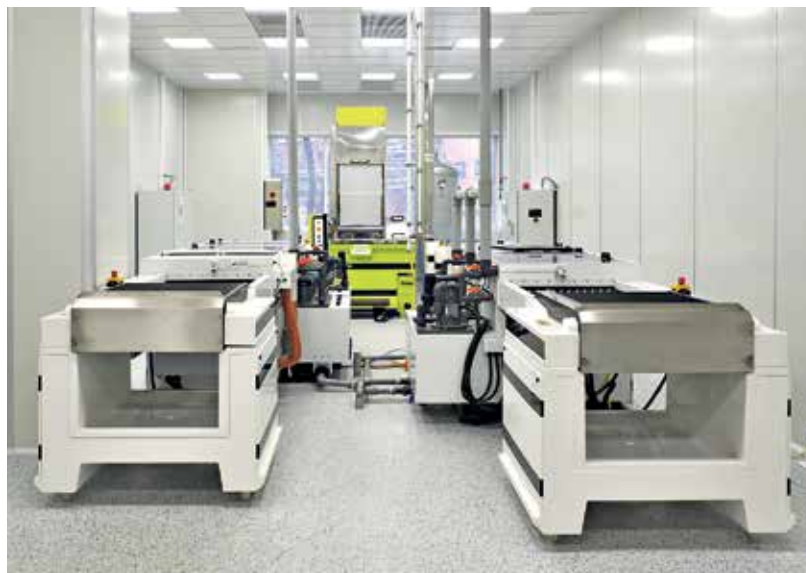
16 Участок горячего облуживания. Слева: установка горячего облуживания Quicksilver; справа: весь комплект оборудования, на переднем плане линия подготовки к облуживанию Pre-Hall (правая) и линия заключительных операций Post-Hall (левая)
