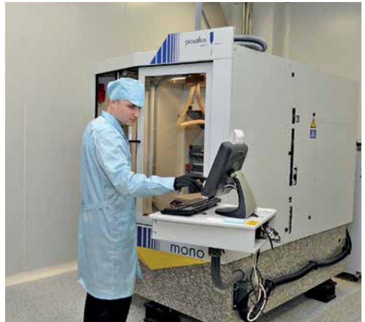
5 Прецизионные станки швейцарской компании Posalux: слева – скоростной трехшпиндельный (модель 3600-LZ); справа – комбинированный сверлильно-фрезерный (модель Ultraspeed Mono Combi)
