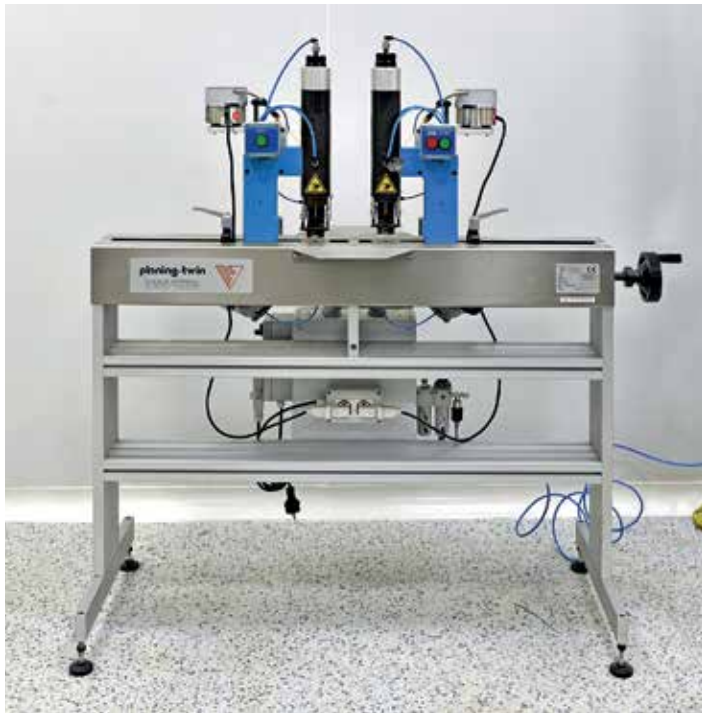
15 Pinning Twin – установка одновременного штифтования двух отверстий в пакете печатных плат. Производитель: VF (Италия)
