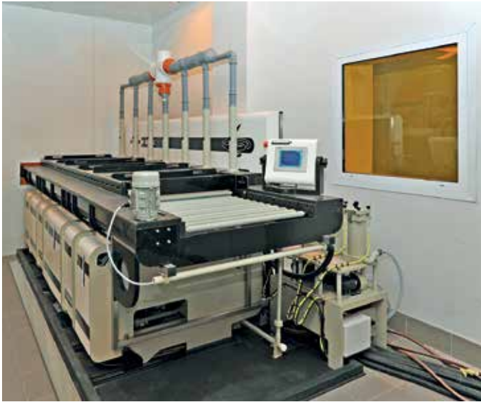
11 Конвейерная установка химической подготовки медной поверхности перед прессованием и нанесением паяльной маски с модулем сушки LD 610 TOP-BOND BO
