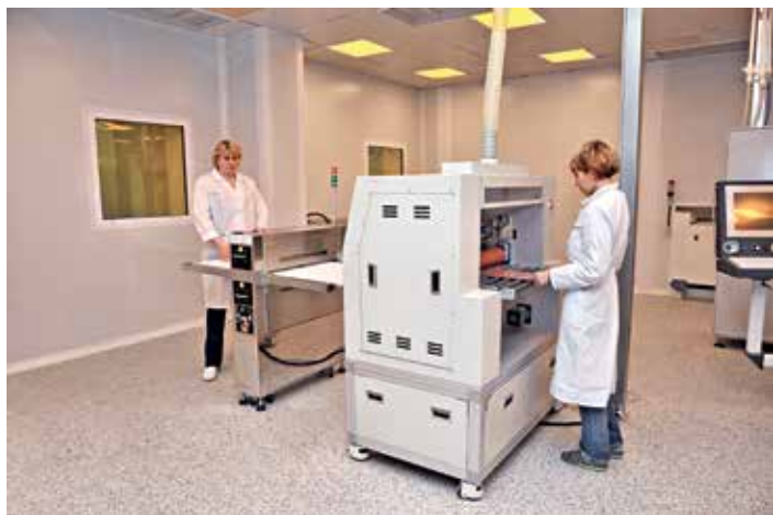
1 Машина для наслаивания пленочного фоторезиста – ламинатор компании OTS (Корея). Слева от ламинатора – установка обеспыливания
