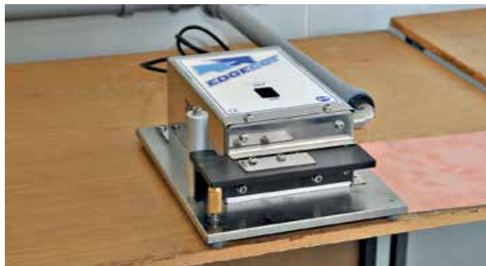
4 Сверху: станок Spinamatic для сверления двух базовых отверстий и штифтования. Производитель — компания VF (Италия). Снизу: установка EdgeCut компании Seetrex (Англия) для обработки кромок печатных плат
