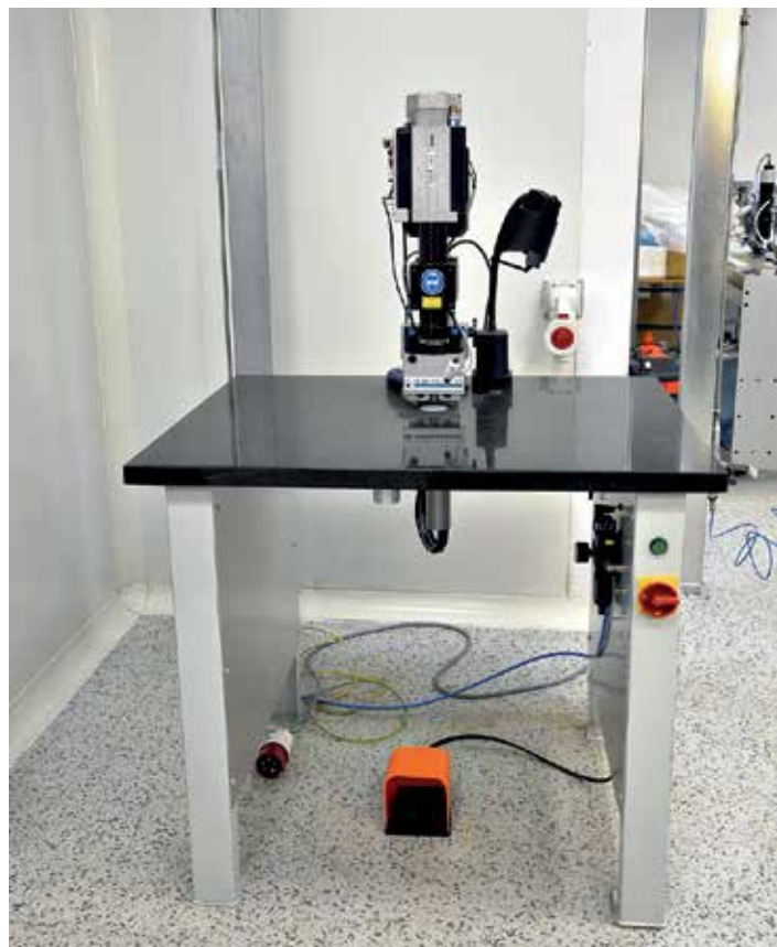
14 Targomil - установка для вскрытия реперных знаков
