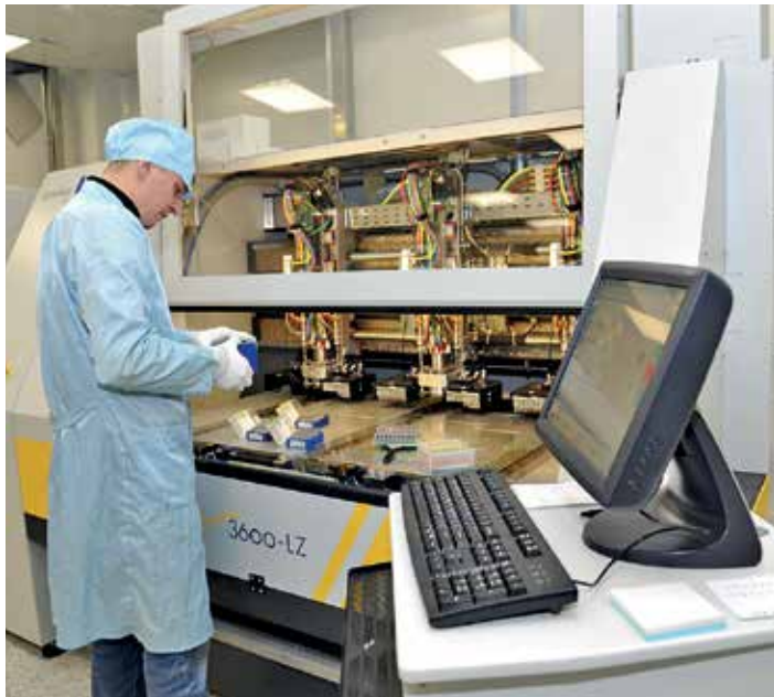
5 Прецизионные станки швейцарской компании Posalux: слева – скоростной трехшпиндельный (модель 3600-LZ); справа – комбинированный сверлильно-фрезерный (модель Ultraspeed Mono Combi)
