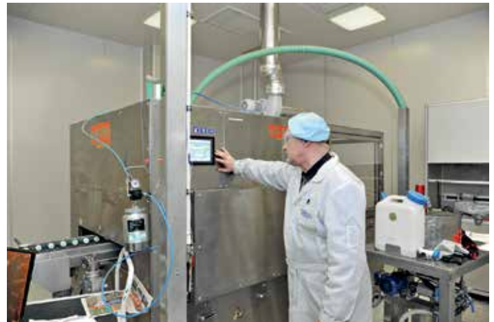
17 Установка струйно-факельного нанесения защитной паяльной маски KU 453 швейцарской фирмы all4 PCB
