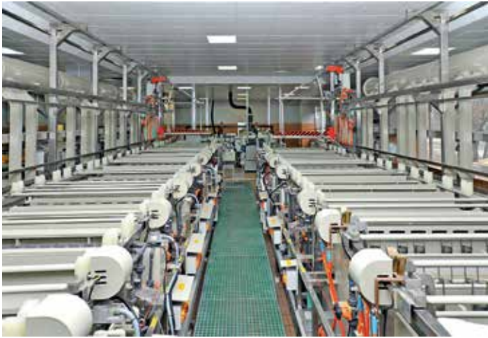
7 Химико-гальваническая линия металлизации печатных плат PAL Galvour: слева – два конвейера линии; справа – шкаф управления с терминалом оператора
