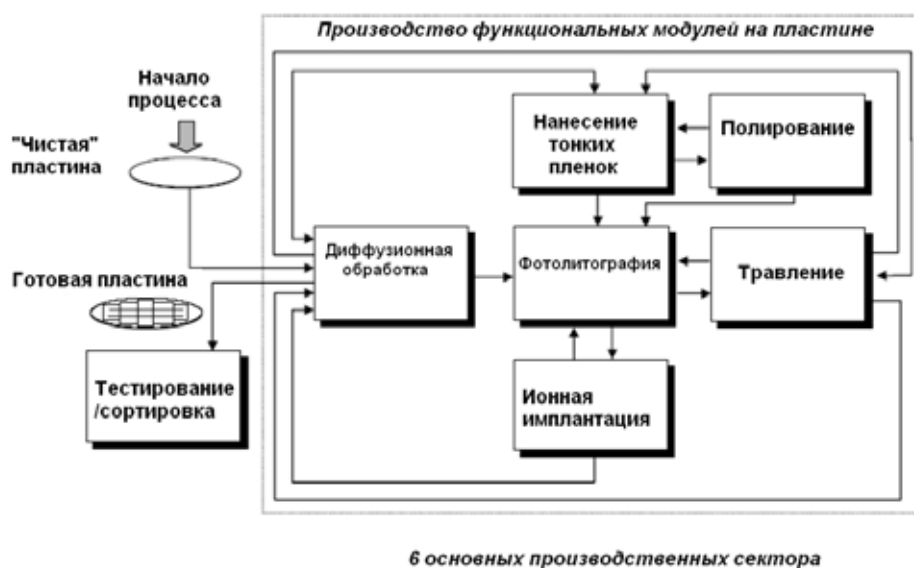
Рис. 4 Базовый технологический маршрут производства МЭМС и ИС
