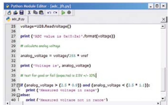
Рис. 4 Пример программы для тестирования АЦП в JTAG Functional Test
