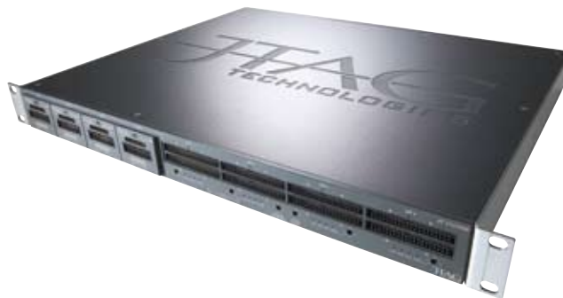
Рис. 5 Контроллер JT3727/RMI. Слева находятся TAP-порты, а справа – цифровые каналы I/O
