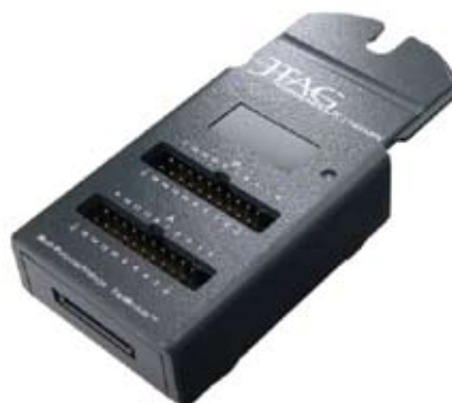
Рис. 6 Модуль JT2149 с поддержкой функции SCIL
