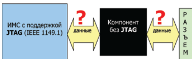
Рис. 2 Проблема с тестированием связей сложного «кластера»
