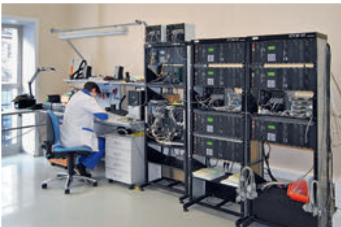
В лаборатории тестирования. Справа от рабочего места инженера-испытателя – стеллаж с испытательным оборудованием, далее – два комплекта стойки КТСМ-02
