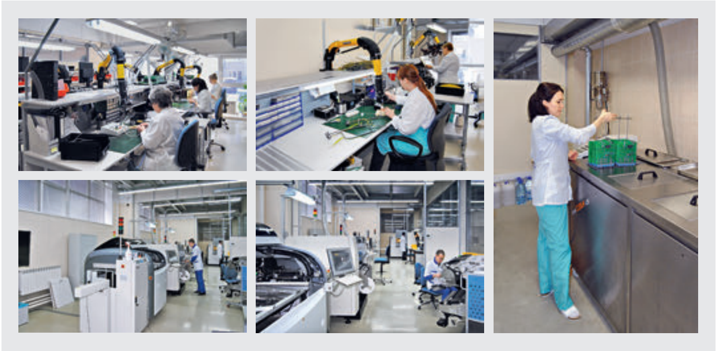
Производство электронных узлов. Рабочие места ручного монтажа; автоматизированная сборочная линия; рабочее место подготовки питателей, установка ультразвуковой отмытки печатных узлов Miniclean компании PBT Works
