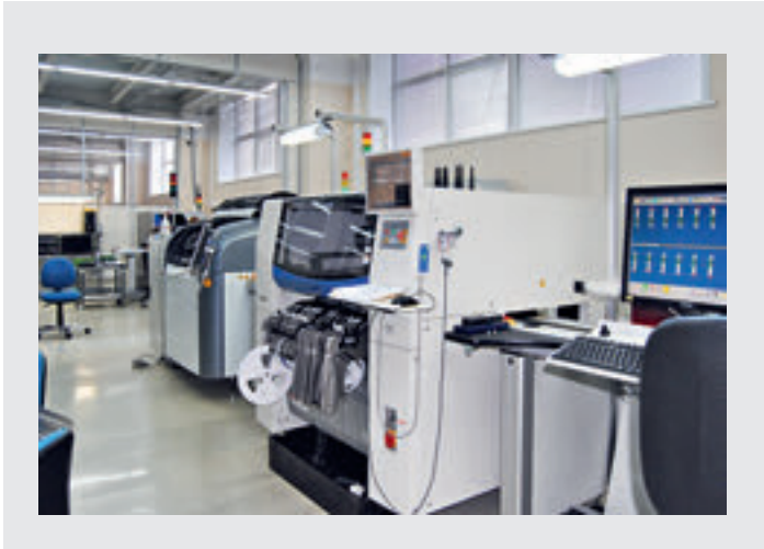
Состав оборудования линии поверхностного монтажа: автомат трафаретной печати DEK HORIZON03iX, инспекционный конвейер Nutek 1NTM 510ICL, автомат установки компонентов Samsung SM 421 и рабочая станция с конвейером Nutek NTM 530WSL, печь оплавления Hotflow 2/12
