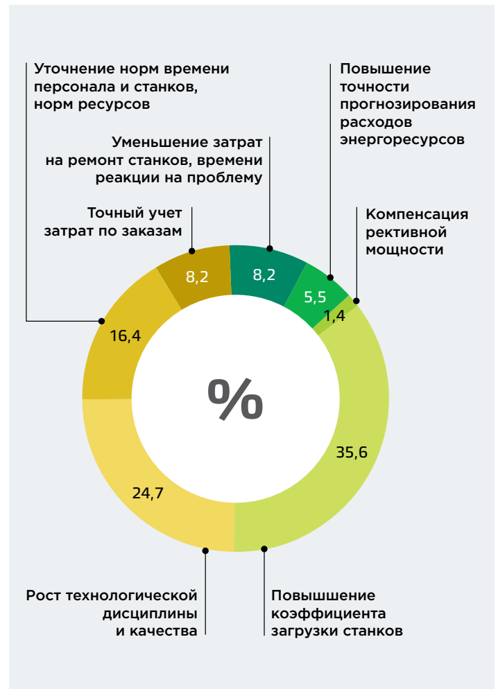
2 Результаты применения ПАК «Синтиз» для повышения эффективности монтажно-сборочного участка на пять единиц оборудования
